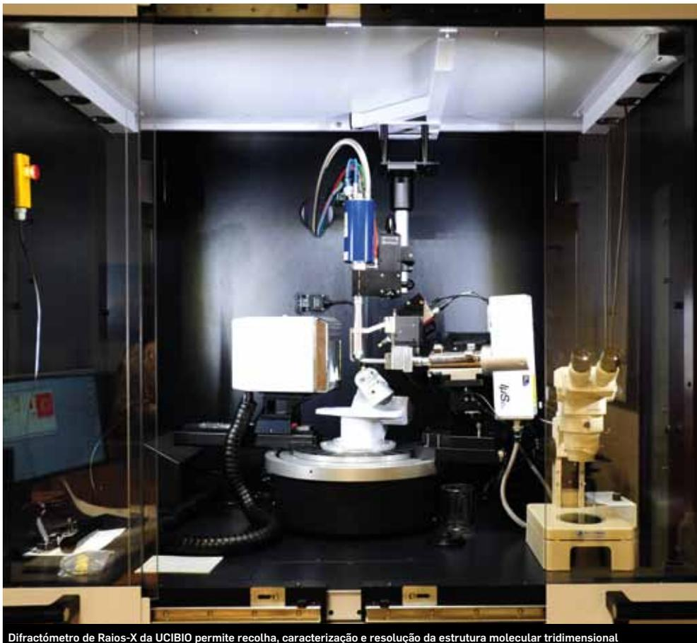
Difracómetro de Raios-X da UCIBIO permite recolha, caracterização e resolução da estrutura molecular tridimensional
